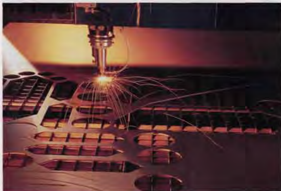
In Versuchen unter Praxisbedingungen haben wir nachgewiesen, daß Laser mit Sauerstoff höherer Reinheit schneller schneiden können, ohne daß die Schnittqualität leidet.
