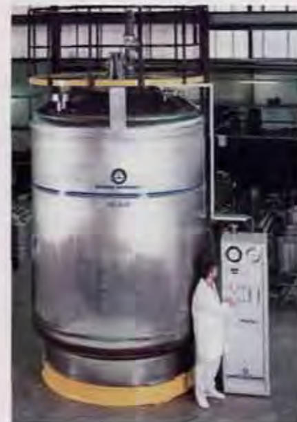
Aus der Forschung erhalten wir häufig Spezialaufträge, zum Beispiel für die Fertigung eines Helium-Großraumbehälters.
