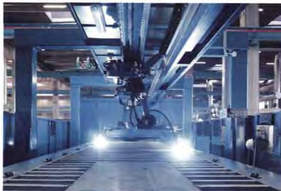
Die von Oxytechnik konzipierte Container-Fertigungsstraße ist mit Schweißportalen und Robotern, unter anderem von Eisenmann & Gissel (Bild rechts), ausgestattet
