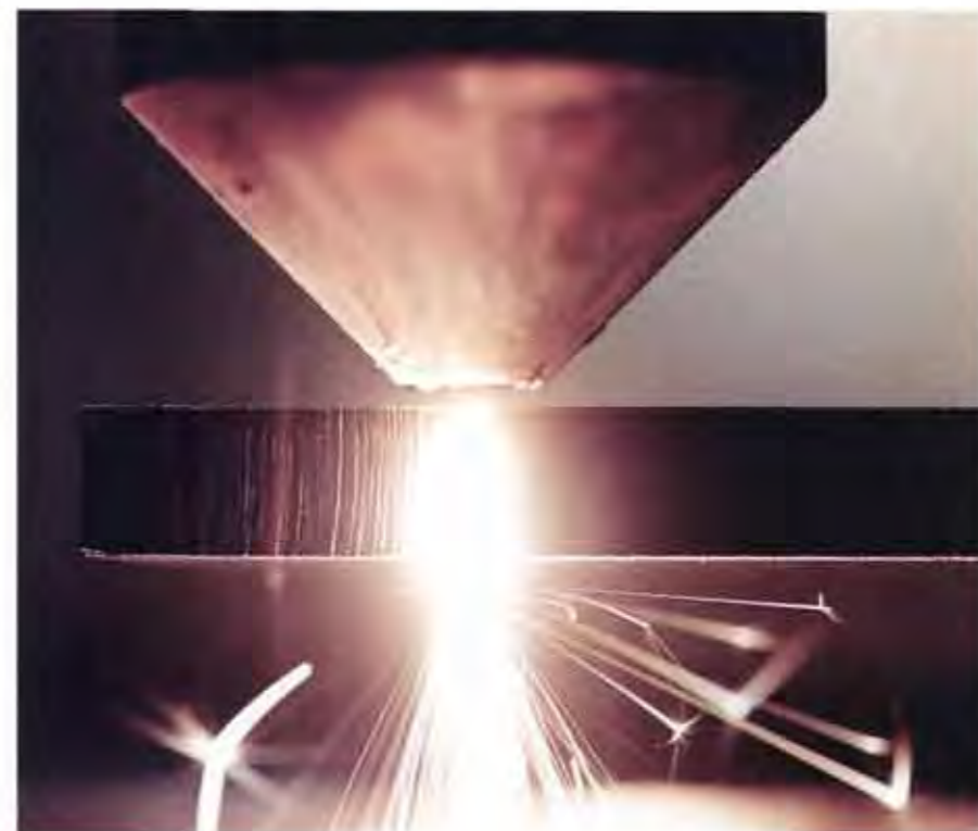
Eine Rarität ist die Aufnahme des offenen Schnitts beim Schneiden mit dem Laser.
