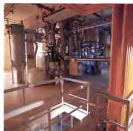
Im Trockenmischzentrum des Maggi-Werks Singen verhindert flüssiger Stickstoff das Verklumpen von Speisezutaten.
