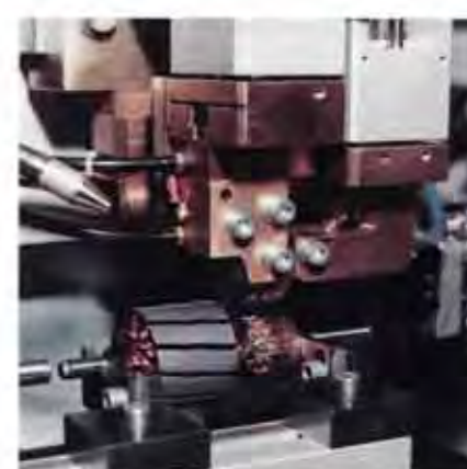
Das neue vollautomatische Widerstandsschweißsystem erlaubt Herstellern von Elektromotoren den Verzicht auf asbesthaltige Werkstoffe.
