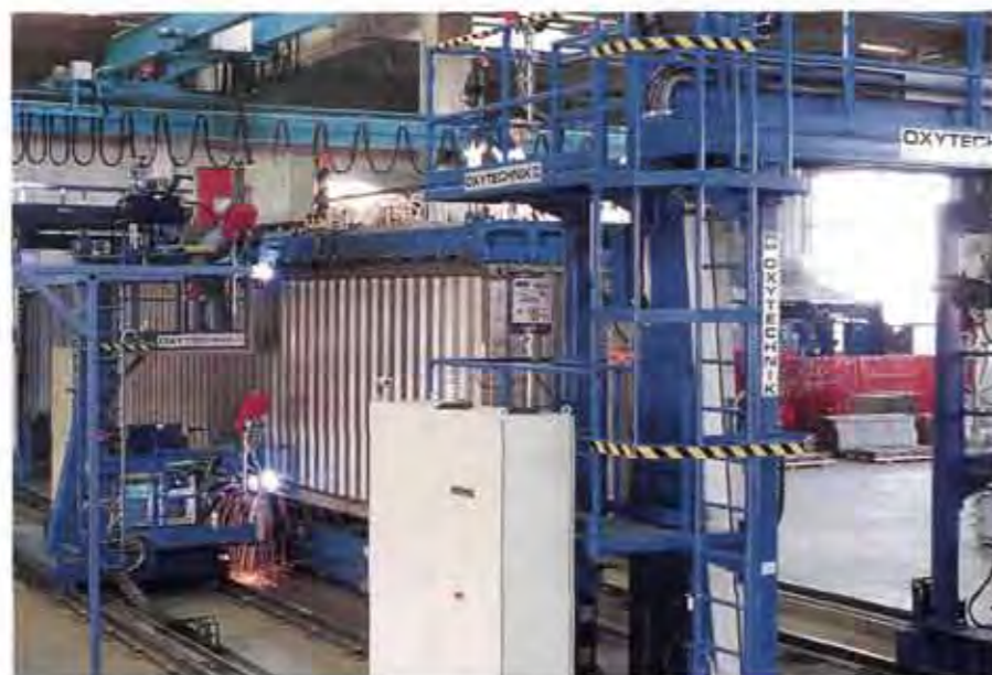
In der von Oxytechnik entwor-fenen Fertigungsstraße schweißen Gerüstträger gleichzeitig die Längsnahte einer Container-Seite an Dach und Boden
