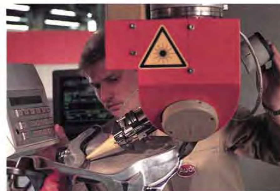
Die Aufnahme der Schnittkontur und die Laserschneidung von Karosserieblechen (Bild rechts) erfolgen bei Audi mit einem Fünf-Achsen-Lasersystem
