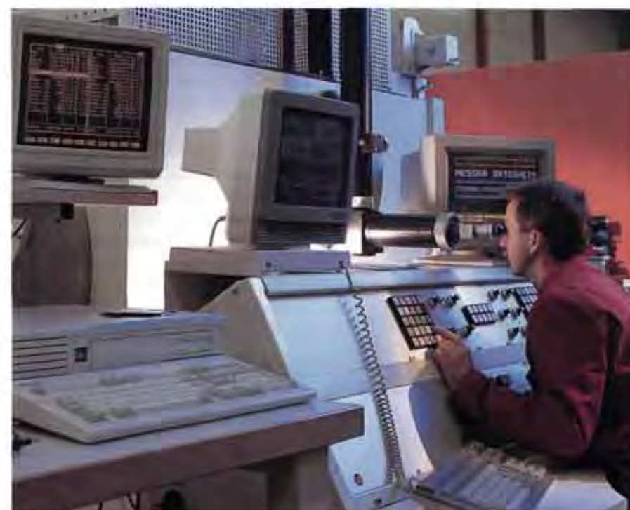
Die CNC-Steuerung des EB-Systems artet die Schweißnaht, verbindet die Bauteile und graviert die Teilenummer.
