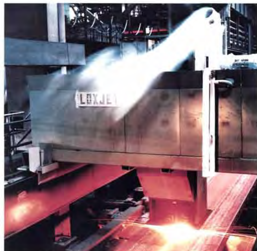
Die Thyssen AG setzt in einem Hüttenwerk die Hochleistungsschneiden mit flüssigem Sauerstoff ein. Messer Griesheim Austria hat das Verfahren gemeinsam mit der Muttergesellschaft entwickelt.
