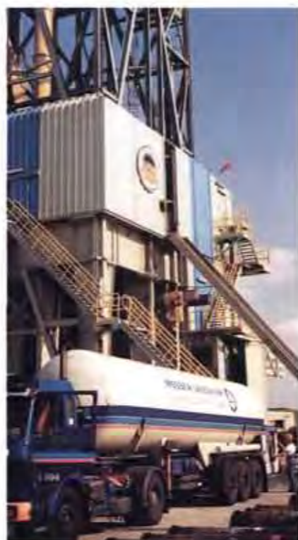
Im bayrischen Windschessbach arbeitet die größte Landbohranlage der Welt. Die Hochdrucktechnik mit Stickstoff dient der Förderung von Gesteinsflüssigkeiten.
