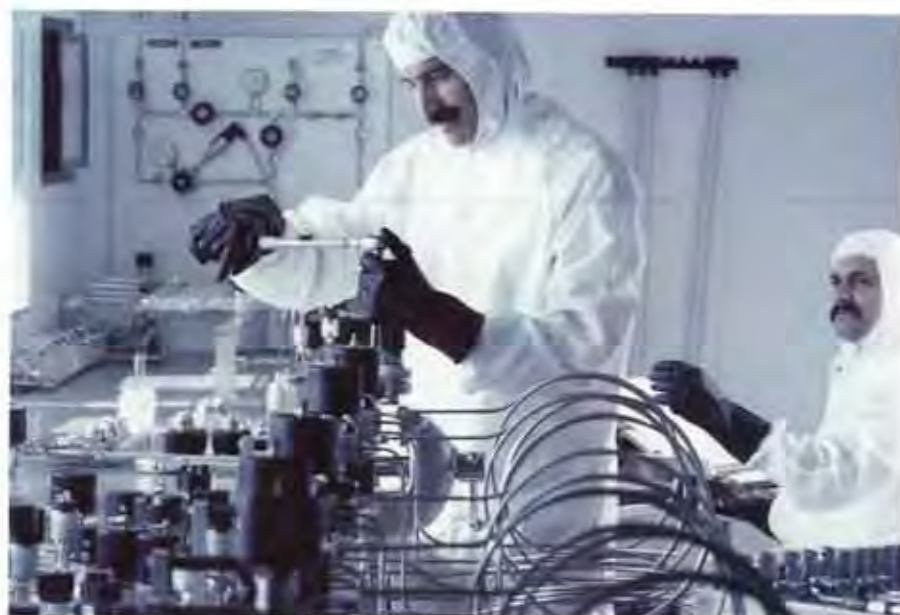
Teil unseres hohen Qualitätsstandards ist die Fertigung von Reinstgasversorgungsarmaturen im Reinraum
