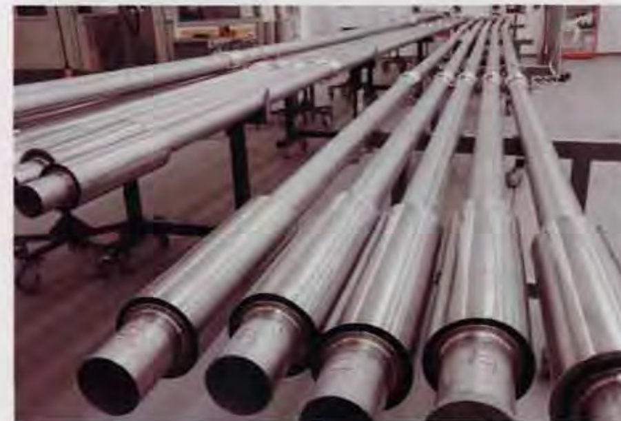
... und von Transferleitungen für flüssigen Sauerstoff und Wasserstoff zum Antrieb von Forschungsraketen.
