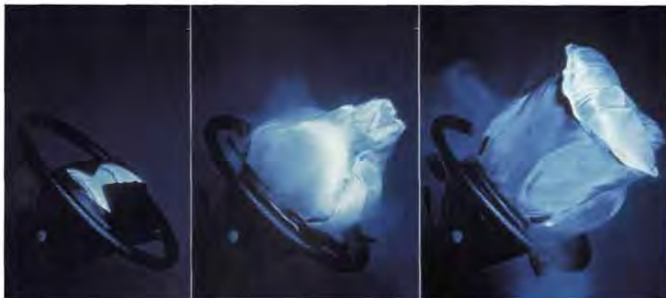
In nur 26 Millisekunden nach der Zündung ist das im Lenkrad eines Mercedes integrierte Airbag in voller Umfang aufgeblasen
